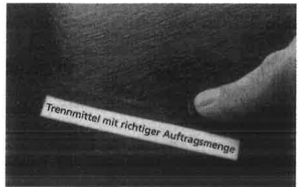
Bild F.4. Schalungshaut mit unterschiedlichen Auftragsmengen, richtige Auftragsmenge (aus [20])
